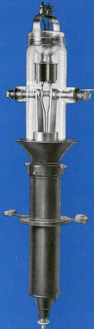
Telephonie bei Verwendung der Röhre als Klasse-B-Verstärker. Die in diesem Falle zulässige Höchstbelastung ist aus nachstehender Tabelle ersichtlich. Die Eingangsleistung darf, entsprechend der Wellenlänge und daher der Anodenspannung, 25 bis 30 kW betragen.
